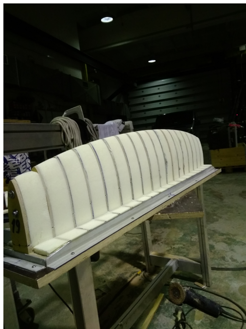
Рис. 1. Этап строительства модели, собранные сегменты корпуса
